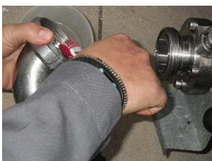
Nettoyage manuel du raccord d'entrée tank
